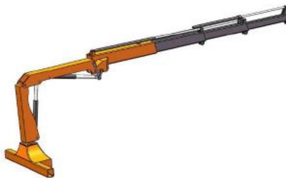
**Figura 1:** Grúa tipo pluma de un camión.
