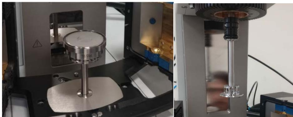
**Figura 4:** Utillaje de la celda de cizalladura inferior y superior.
