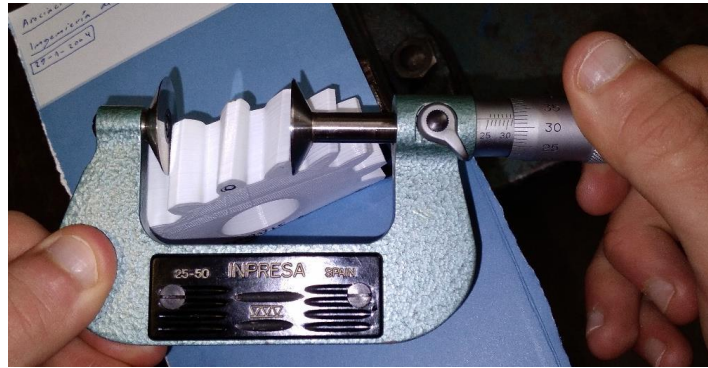
Figura 9: Medición con micrómetro de platillos: (a) Indicación de la distancia cordal W en una rueda helicoidal; (b) Medición de la distancia W con un micrómetro analógico. Fuente: Modificado de [12]
