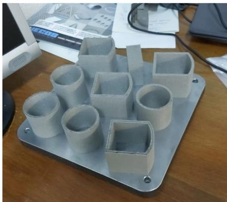
**Figura 2:** Piezas fabricadas mediante PBF-LB.
