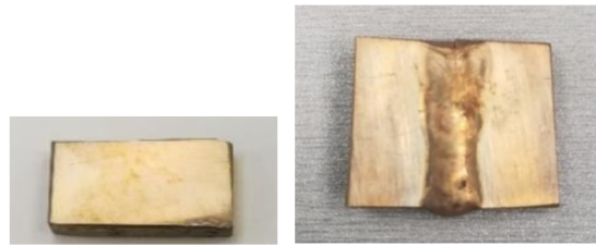
Figura 3: Probeta individual (izda.) y probetas ya soldadas (dcha).
