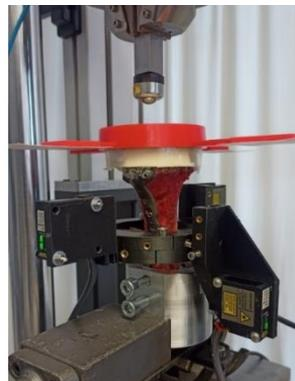
(a) Montaje del espécimen en la máquina
