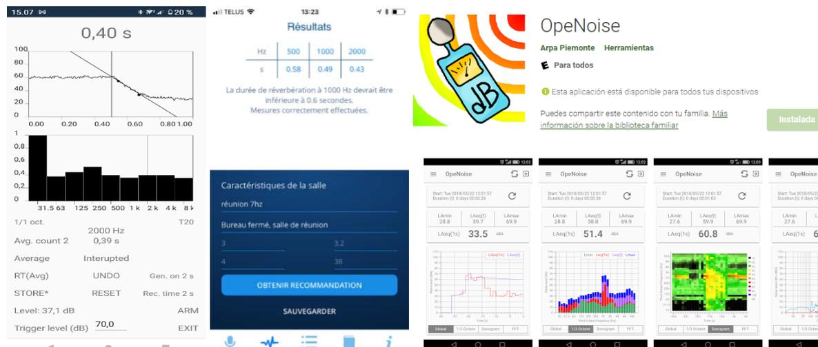
**Figura 5:** Aplicaciones para la medida de tiempo de reverberación. (Izquierda) Artim USB Reverberation Meter disponible para Android, (centro) ClapReverb disponible para IOS. OpeNoise, analizador acústico en bandas de tercio de octava, (derecha), para Android e IOS.
