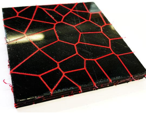
(a) Vista superior de la estructura tipo nácar.
