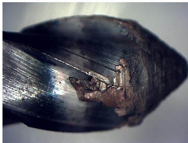
Figura 3: Herramienta al final de su ciclo de vida
