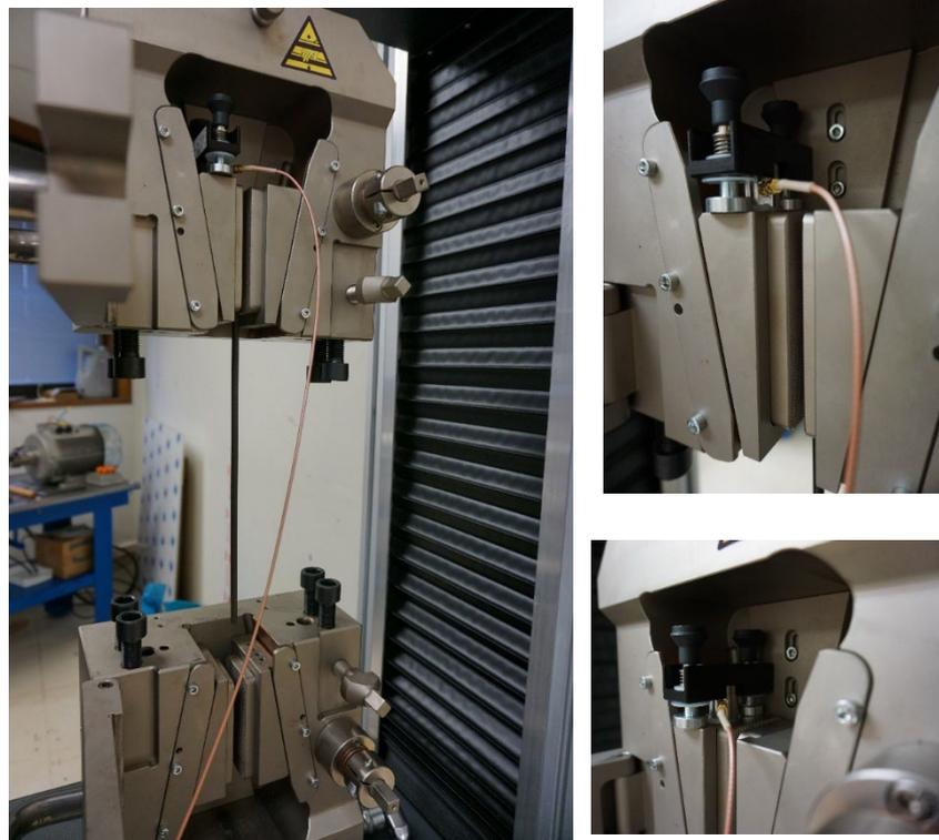
**Figura 1:** Configuración de la máquina y posicionamiento del sensor de EA en los ensayos de tracción del alambre.
