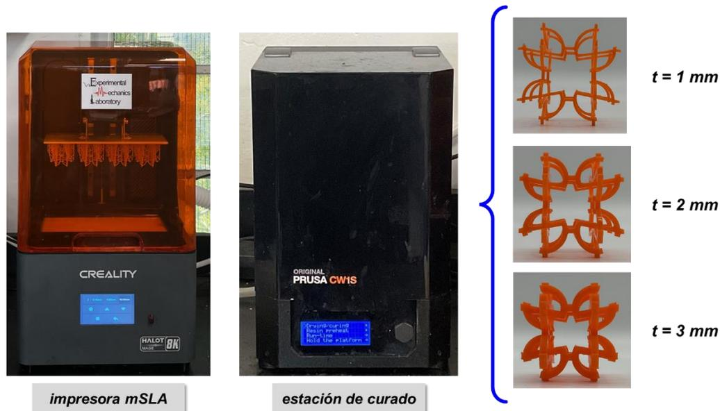
**Figura 2.** Impresora mSLA y estación de curado usados para la fabricación de las probetas analizadas. Se imprimieron probetas de distintas anchuras,  $t = 1$  mm, 2 mm y 3 mm.
