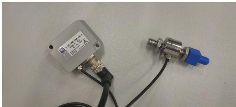
**Figura 5:** Célula de carga empleada.
