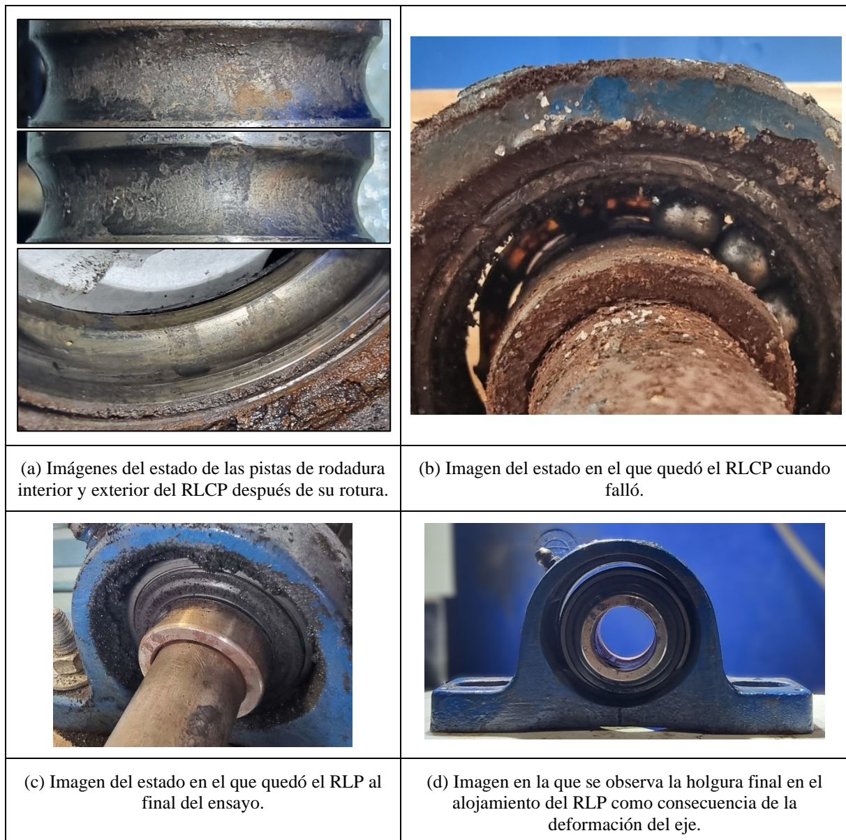
Figura 7: Imágenes del estado en el que quedaron los rodamientos después del ensayo.
