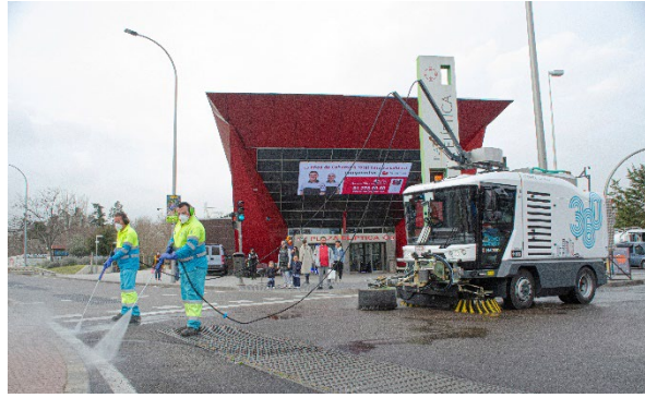
Figura 3: Modo de operación con operario en cabina y en labores de limpieza
