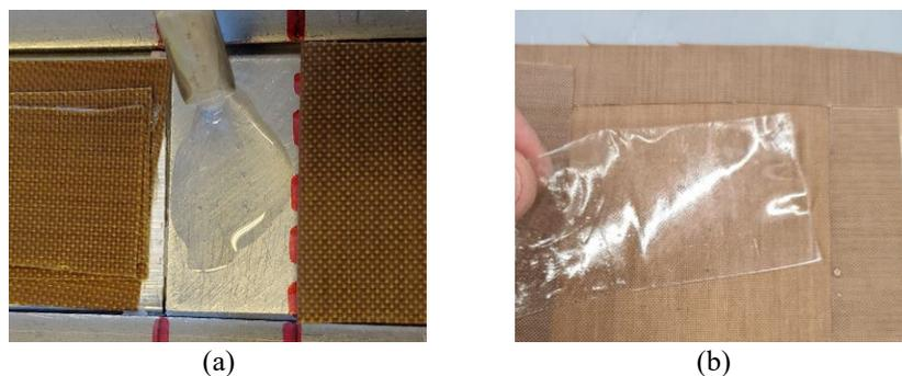
**Figura 1:** Materiales intermedios (tras la primera etapa de curado). (a) ratio-0.4 y (b) ratio-0.6
