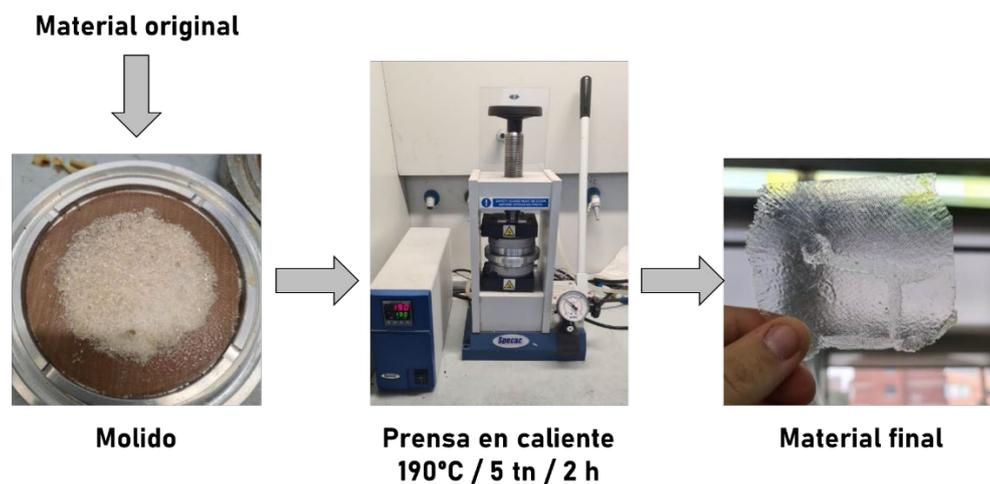
**Figura 6:** Pruebas cualitativas del proceso de reciclado para el material ratio-0.6
