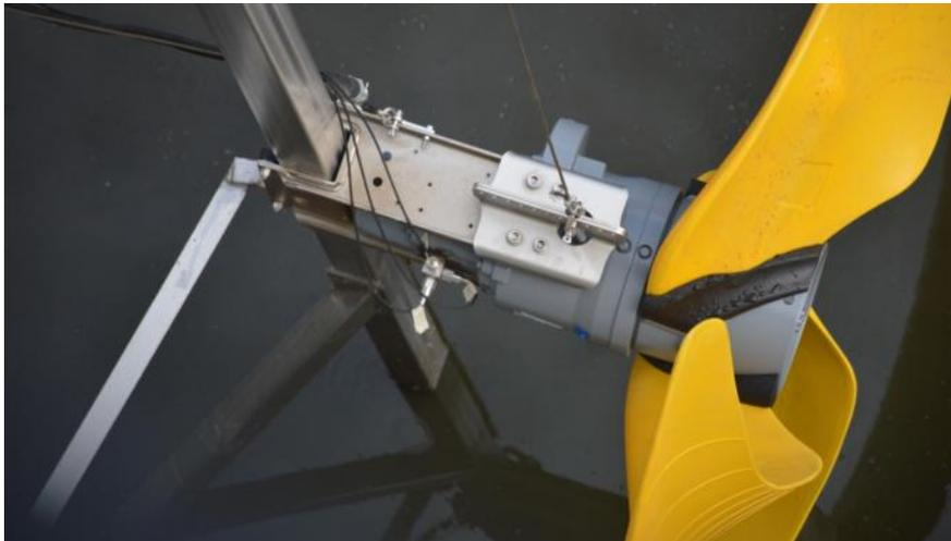
**Figura 25:** Acelerómetro triaxial en el agitador antes del ensayo
