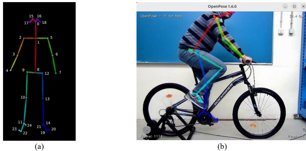
Figura 5: Numeración de las coordenadas extraídas con OpenPose (a) [8] y ejemplo de postura humana (b).
