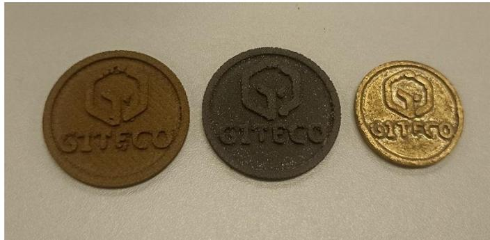
**Figura 2:** Pieza impresa, tras el debinding y tras el sinterizado.
