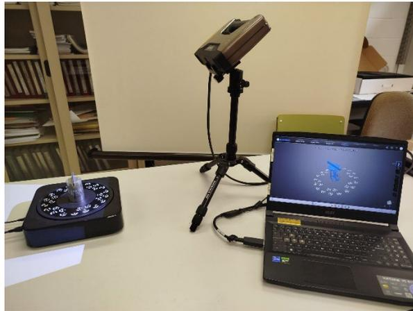
**Figura 4:** Escaneo fijo con plataforma giratoria del escáner Einscan Pro HD.
