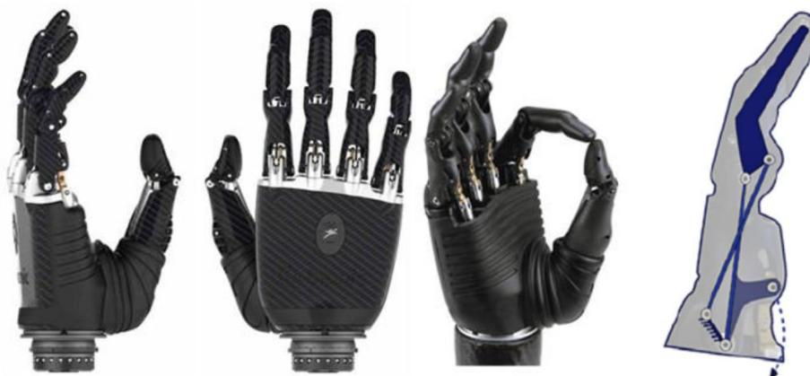
Figura 1: Prótesis BeBionic. Aspecto y funcionamiento [5].
