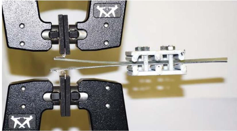
**Figura 3:** Ensayo ADCB utilizando un conector mecánico.
