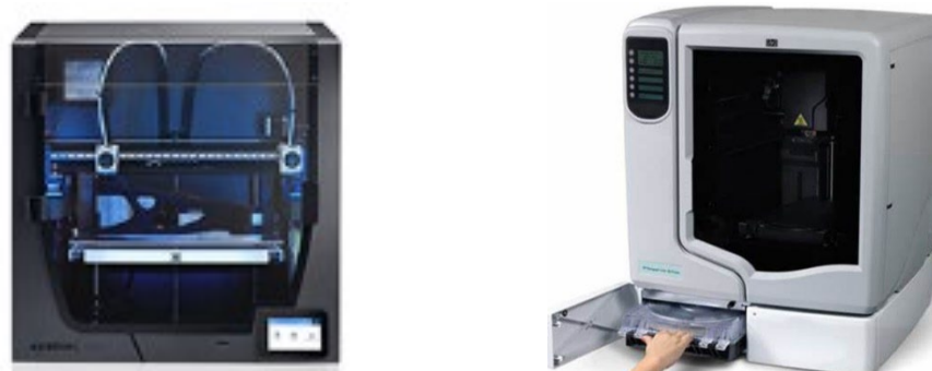
Figura 1: Impresoras utilizadas, tecnología FDM, materiales ABS y PLA.
