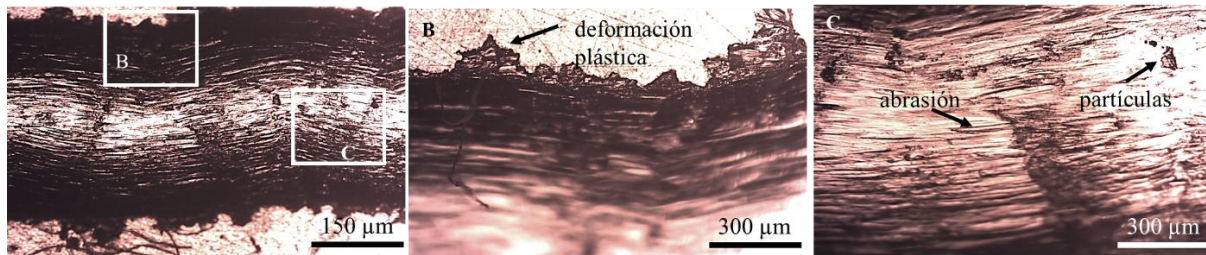
Figura 7: Mecanismos de desgaste identificados en la muestra de HDSS2 ensayada a 17N de carga. (A) Detalle del surco de desgaste x5 (MO), (B) Ampliación zona del filo x10(MO), (C) Ampliación zona interior x10(MO).
