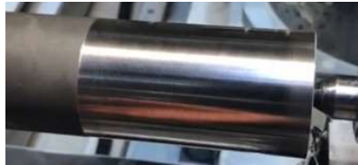
Figura 2: Aspecto de la pieza después del proceso de desbaste
