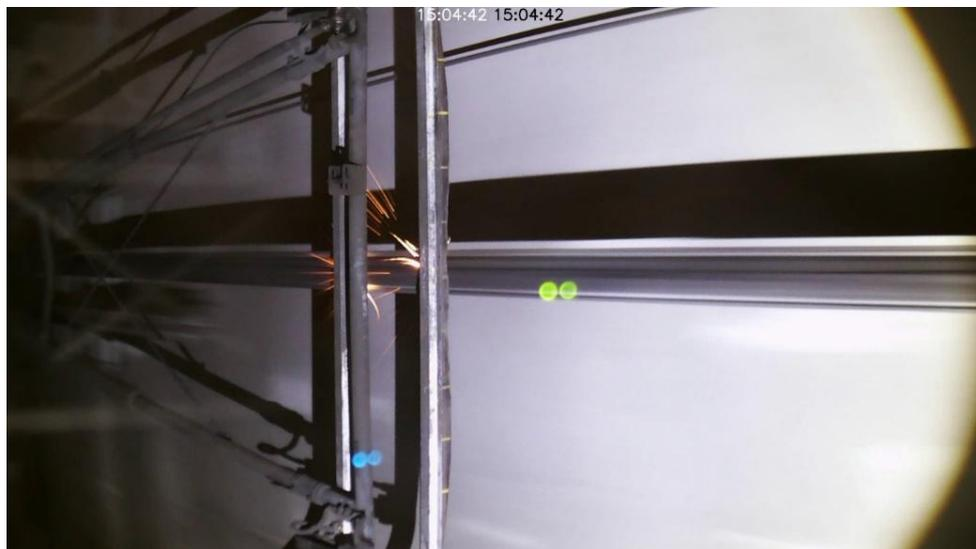
**Figura 6:** Muestra de arco eléctrico capturado por la cámara
