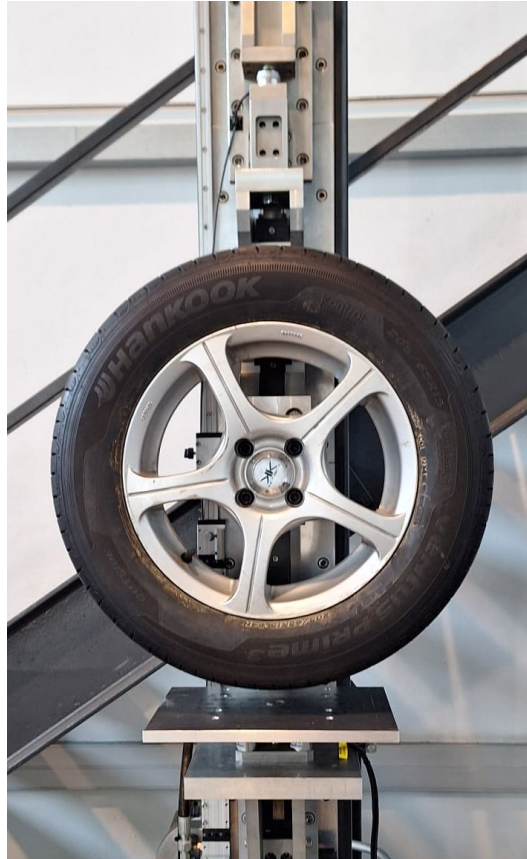
Figura 4: Banco de ensayo de carga vertical del Departamento de Ingeniería Mecánica de la UMA.
