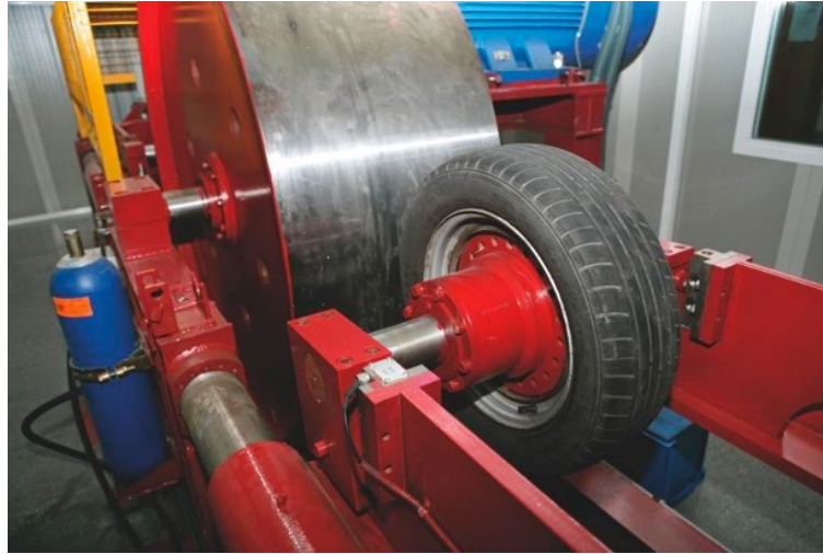
Figura 3: Banco de rodadura del Laboratorio de Vehículo de la UMH.
