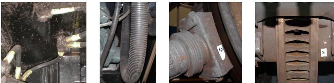
**Figura 2:** Ejemplos de elementos seleccionados para la recogida de muestras para los ensayos de velocidad de cesión de calor a pequeña escala.
