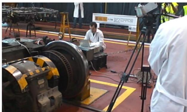
**Figura 16:** Vista de las mediciones en el banco de pruebas para bogies.
